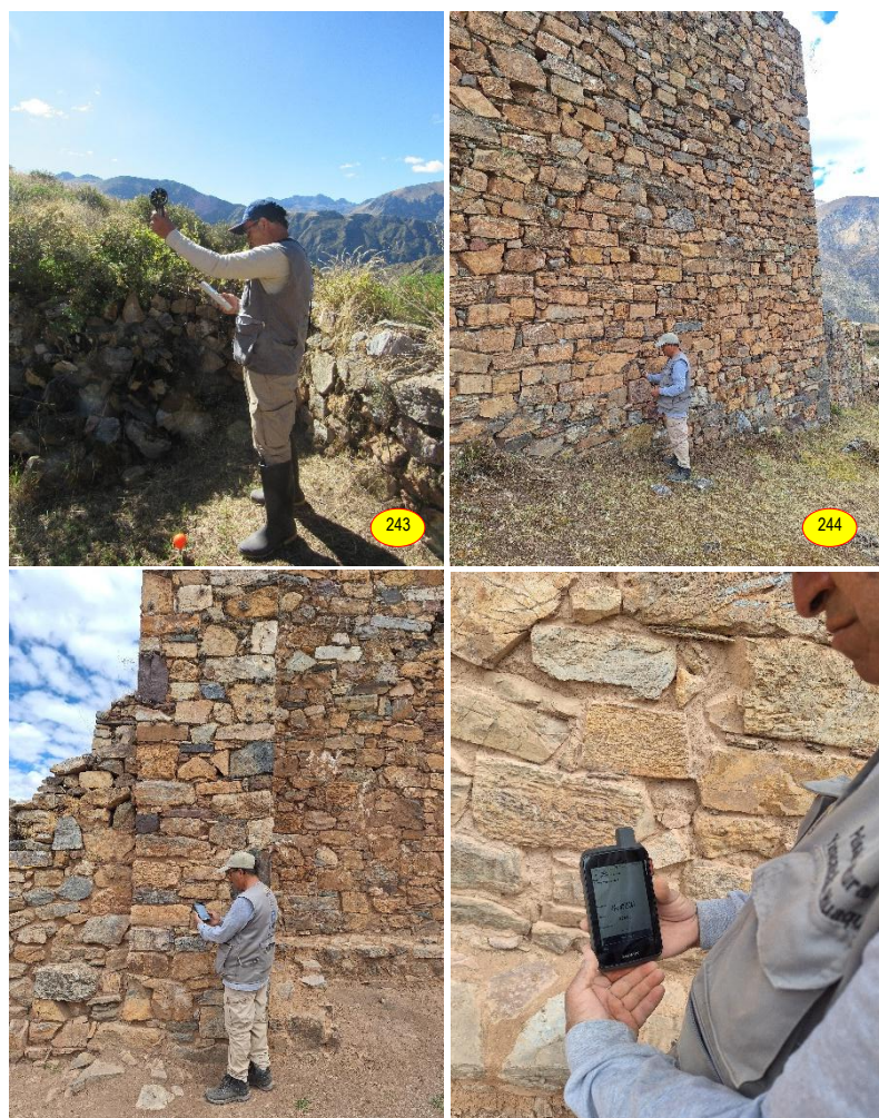
Figs. 243 a 246: Uso e instalación de los equipos para el monitoreo de las condiciones meteorológicas en la Iglesia y torre exenta del Pueblo antiguo de Huaquis.
